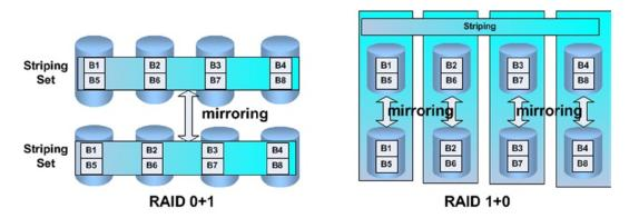
*Figure 5-2. RAID* 0+1 *vs. RAID* 1+0
